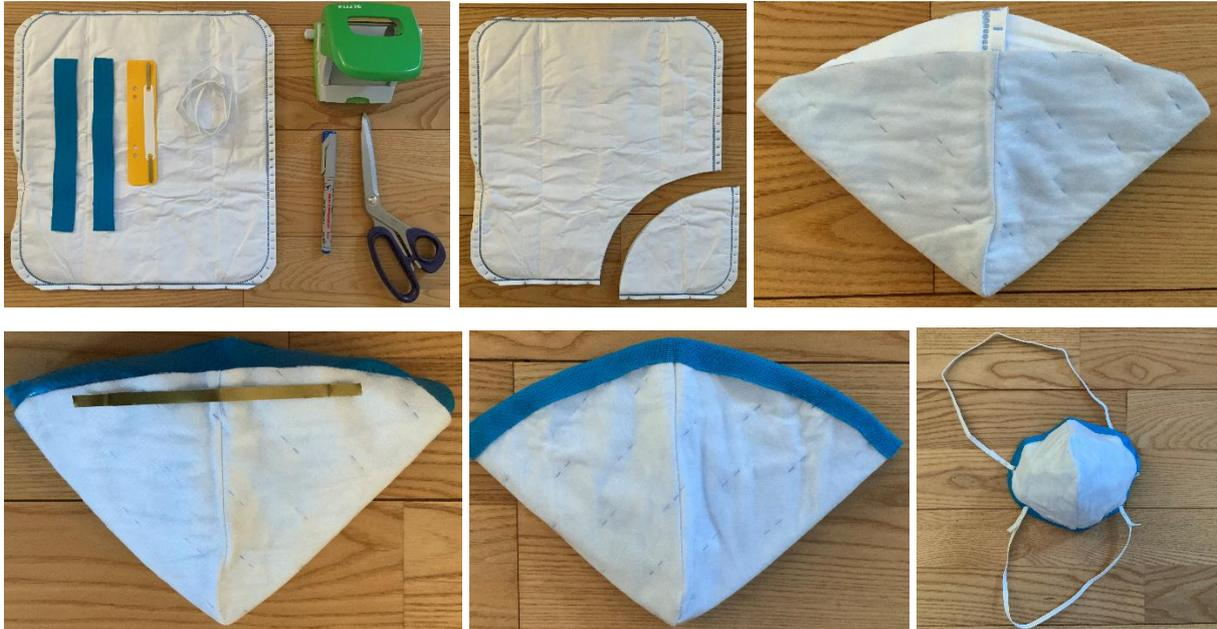
*Benötigte Materialien zur Fertigung einer Maske und die verschiedenen Fertigungsstufen von links oben nach rechts unten*
